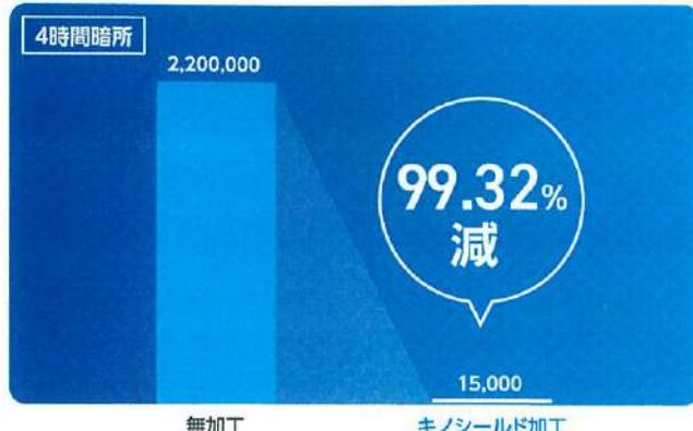
試験規格: JIS R 1756:2013 (可視光応答型光触媒、抗ウイルス(バクテリオファージ))
